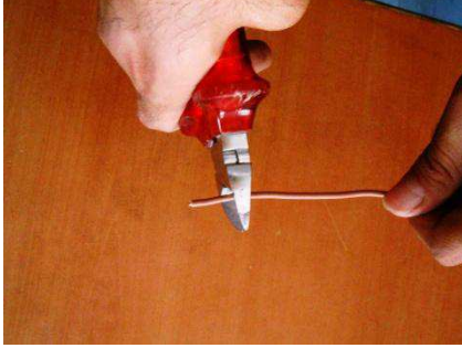
Resim1.38: Kablonun yan keski ile soyulması ve klavuza tutturulması
