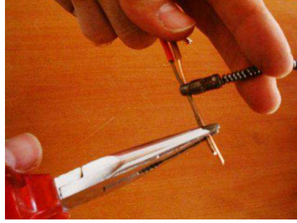
Resim1.38: Kablonun yan keski ile soyulması ve klavuza tutturulması
