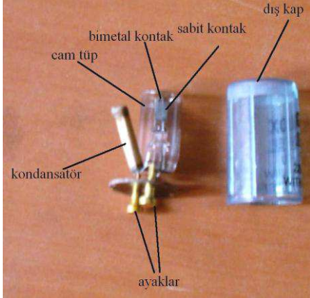
Resim 4.8: Starterin iç yapısı
