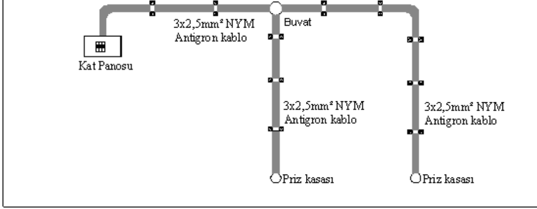
Şekil 3.3: Kabloların döşenip buvat bağlantılarının yapılması
