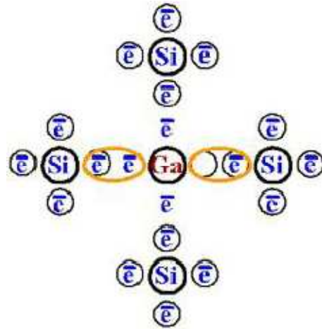
Şekil 11.5: P tipi yarı iletkenin oluşumu
