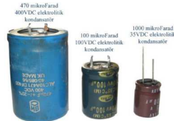
Resim 9.6: Karşılaştırmalı olarak gösterilmiş kutuplu ve kutupsuz elektrolitik kondansatörler
