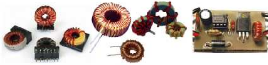
Resim 3.3: Çeşitli toroid bobinler ve bir devre üzerinde kullanılmış hali.
