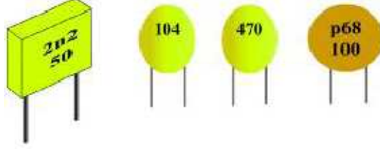
Şekil 9.7: Değerleri kısaltmalarla gösterilen bazı kondansatörler
