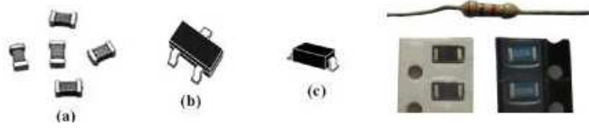
Şekil 8.5: Yüzey temaslı dirençler (SMD) ve Karbon dirençle boyut bakımından karşılaştırması (a) EIA481 Kılıf (b) SOT-23 Kılıf (c) SOD-123 Kılıf
