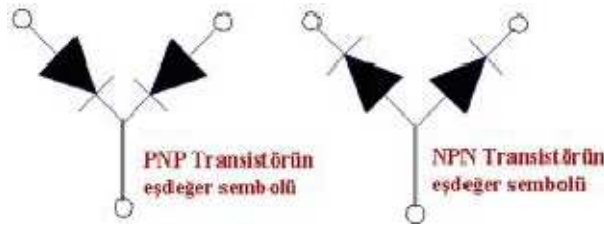
Şekil 13.9: Transistörün eşdeğer modelleri
