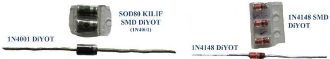
Şekil 12.5: Bazı kristal diyotlarla SMD diyotların karşılaştırılması
