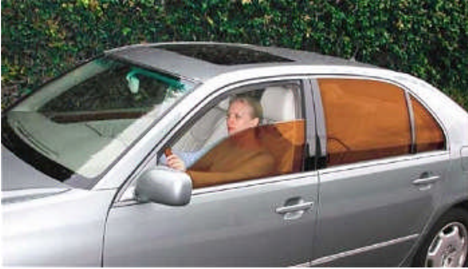
Fotoğraf 1.6. :Araba camına yapıştırılmış jelatin filtre
