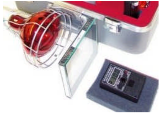
Resim 1.8, 1.9, 1.10. ve 1.11: Işık geçirgenliği ölçen aletler ve kullanımları
