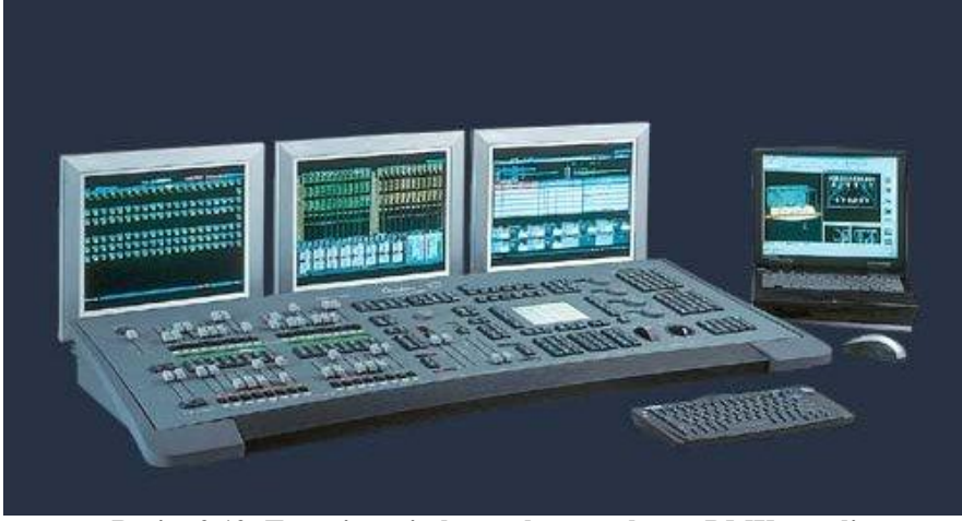
Resim 2.12: Tüm sistemin kontrolünü sağlayan DMX paneli
