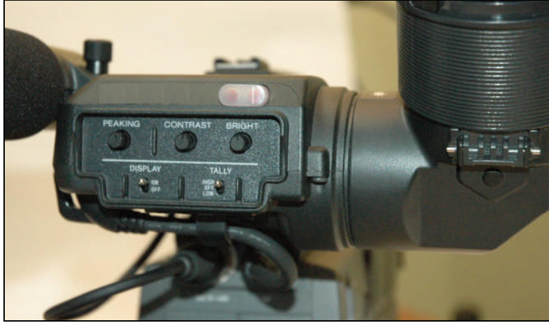
Resim 1.1. Bakacın ön panelindeki düğmeler
