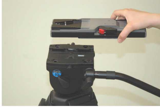
Resim 7: Kamera kazağının ayaklık üzerine yerleştirilmesi
