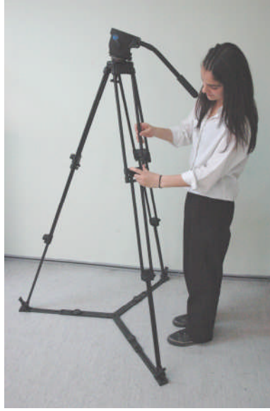
Resim 3 ve 4: Profesyonel bir ayaklığın tam açık ve kapalı hali. Ayaklığın kontrol dışında kaymasını ve yayılmasını engellemek için ayakların arasına “örümcek” adı verilen aparat takılmıştır.
