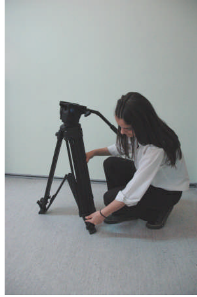
Resim 3 ve 4: Profesyonel bir ayaklığın tam açık ve kapalı hali. Ayaklığın kontrol dışında kaymasını ve yayılmasını engellemek için ayakların arasına “örümcek” adı verilen aparat takılmıştır.
