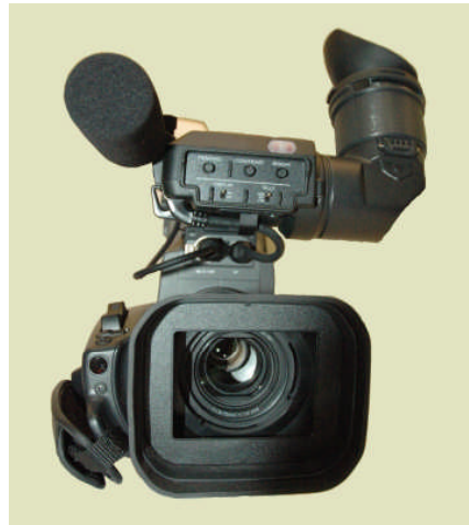
Resim 6: Bakacın ayarları, kendi üzerinde veya objektifin üst tarafında yer alan düğmelerle yapılı
