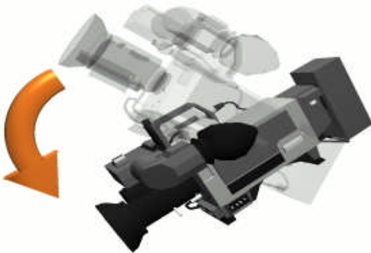
Resim 17: Kameranın dikey çevrinme(tilt) hareketi
