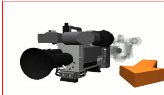
Resim 19 Kameranın yer deęiřtirerek yaptığı truck hareketi
