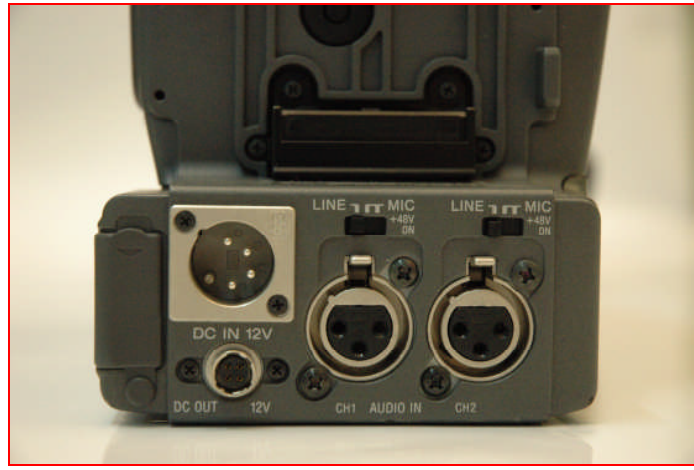
Resim 14: Kamera arkasındaki DC giriş ve çıkışları (solda) ile iki adet mikrofon giriş (sağda).
