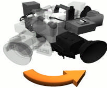
Resim 16: Kameranın yatay çevrinme(pan) hareketi
