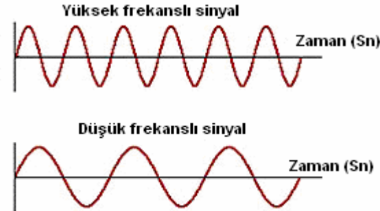
Şekil 1.3: Yüksek frekanslı sinyal ile düşük frekanslı sinyalin karşılaştırılması
