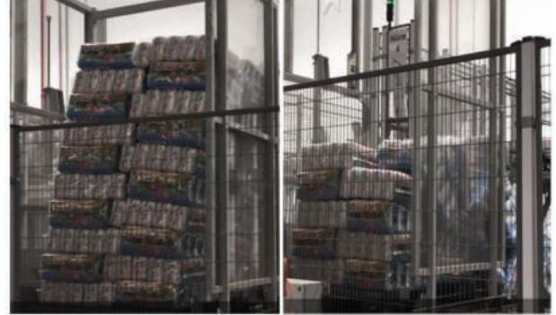
Şekil 2. Palet Üzerinde Dizim Sırasında Torbaların Birbirinden Ayrılması
