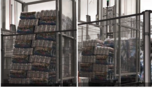
Şekil 1. Taşıma Arabasının İvmelenmesine Bağlı Olarak Devrilmeler
